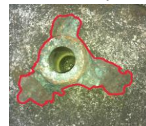
図3 腐蝕したスクリュー
